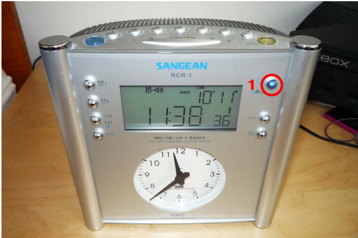
Abbildung 4 Einstellen des Senders mit dem geweckt werden soll
